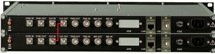
Рисунок 16: Образец подключения синхронизации двух многоканальных генераторов MCSG через опорный генератор в 3 ГГц.
